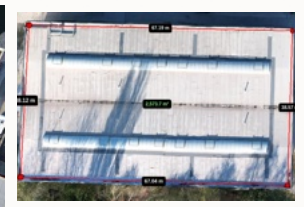
Vermessung eines Daches zur Planung einer PV-Anlage
